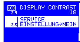
**2.5 Service Einstellungen** – Nachdem der Wert JA während des Anzeigens dieser Option eingestellt und mit der Taste OK bestätigt worden ist, werden alle Parameter gelöscht und ihnen die vorher durch einen Installateur bzw. einen Servicetechniker vorprogrammierten Werte zugeschrieben.
