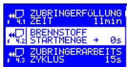
**4.1 Zeit der Füllung des Zubringers** – der Parameter bestimmt, wie lange der Zubringer in Betrieb sein sollte, damit der Hauptzubringer mit dem Brennstoff nachgefüllt wird.
