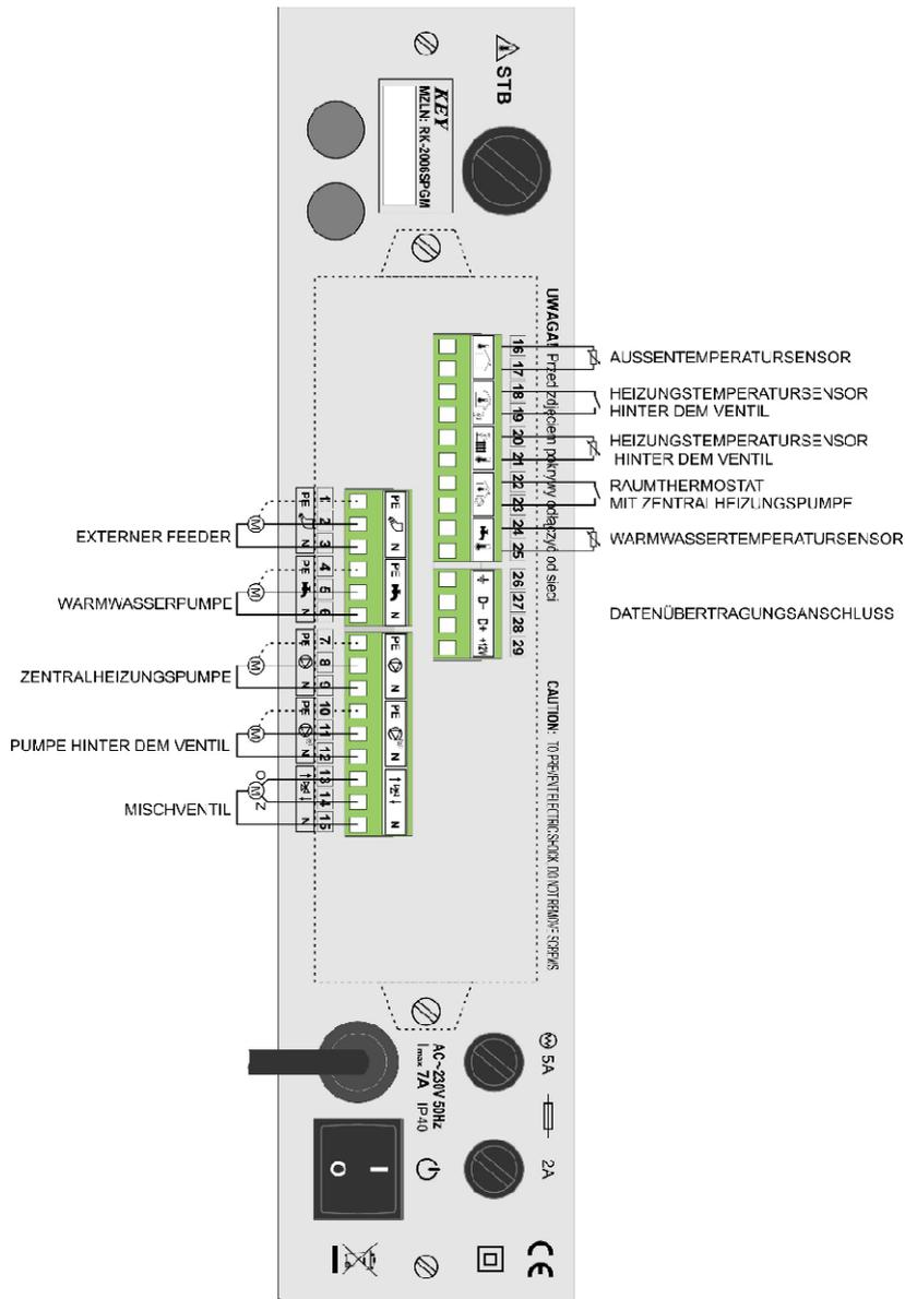
Anschlussschaltplan des Reglers RK-2006SPGM mit Netzgerät MZLN.
