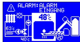
**ACHTUNG!** Der Alarm führt nicht zum Einschalten des internen Hörmelders und braucht nicht gelöscht zu werden. Nach dem Wiederschließen von Kontakten des Sicherheitseingangs wird der Steuerungsvorgang ab einem Zeitpunkt, zu dem er unterbrochen wurde, fortgesetzt.
