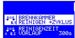
**6.1 Modus Reinigung der Feuerstelle** – der Parameter bestimmt die Betriebsweise des Reinigungsmechanismus:
