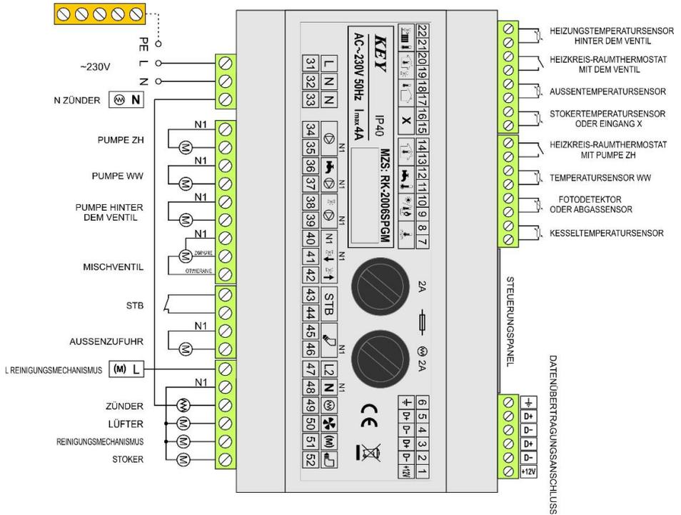
Anschlusschaltplan des Reglers RK-2006SPGM mit Netzgerät MZS Version V.06.2015
