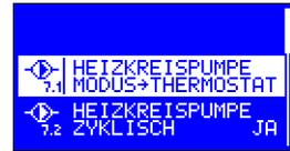
**7.1 Einschaltungsmodus der Heizungspumpe** – der Parameter bestimmt die Weise, auf die die Heizungspumpe eingeschaltet wird. Die Einstellung des Werts TERM bedeutet, dass die Heizungspumpe nur bei geschlossenen Kontakten des Raumthermostats und in Notfällen (z.B. Kesselüberhitzung) eingeschaltet wird. Das Vorprogrammieren des Werts AUTO bedeutet, dass die Heizungspumpe unabhängig vom Raumthermostat betrieben wird.
