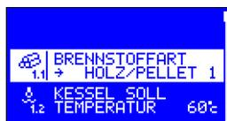
**ACHTUNG!** Die Änderung der Brennstoffart kann nur dann durchgeführt werden, wenn der Regler sich im Modus STOP befindet.
