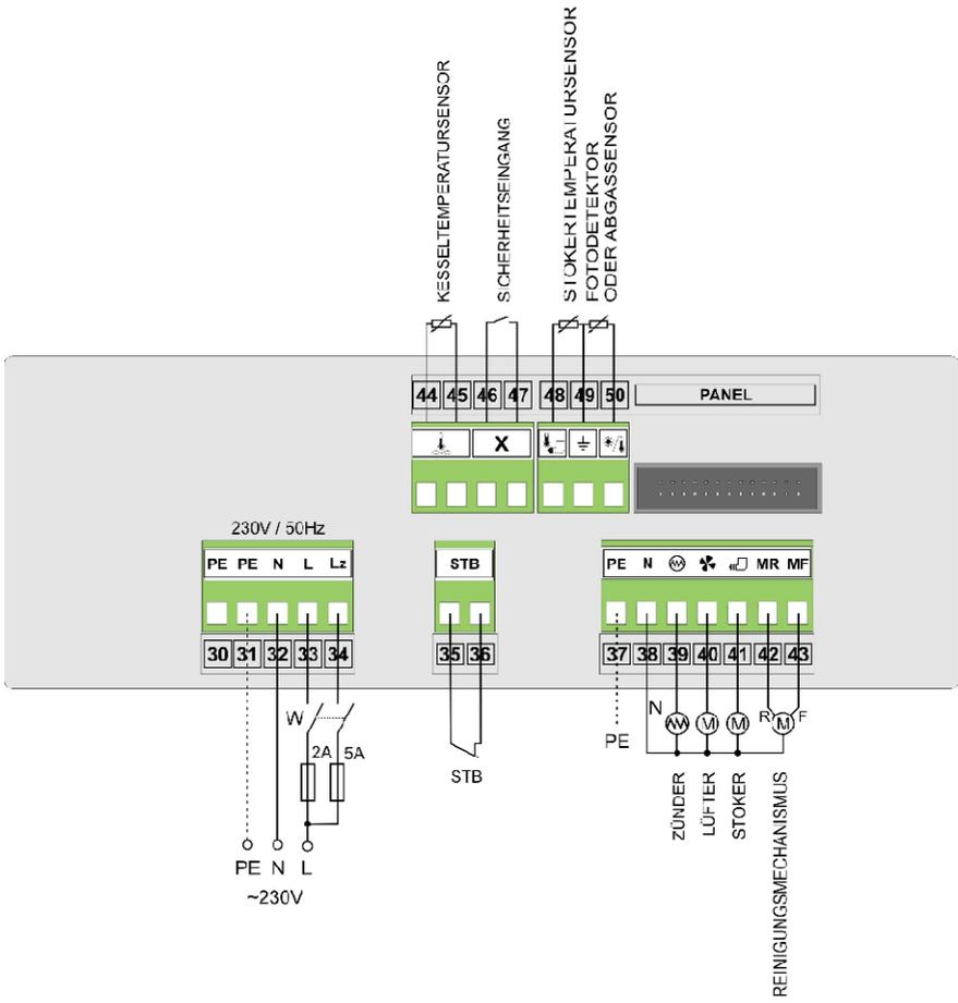
Anschlussschaltplan des Reglers RK-2006SPGM mit Netzgerät MZLN.
