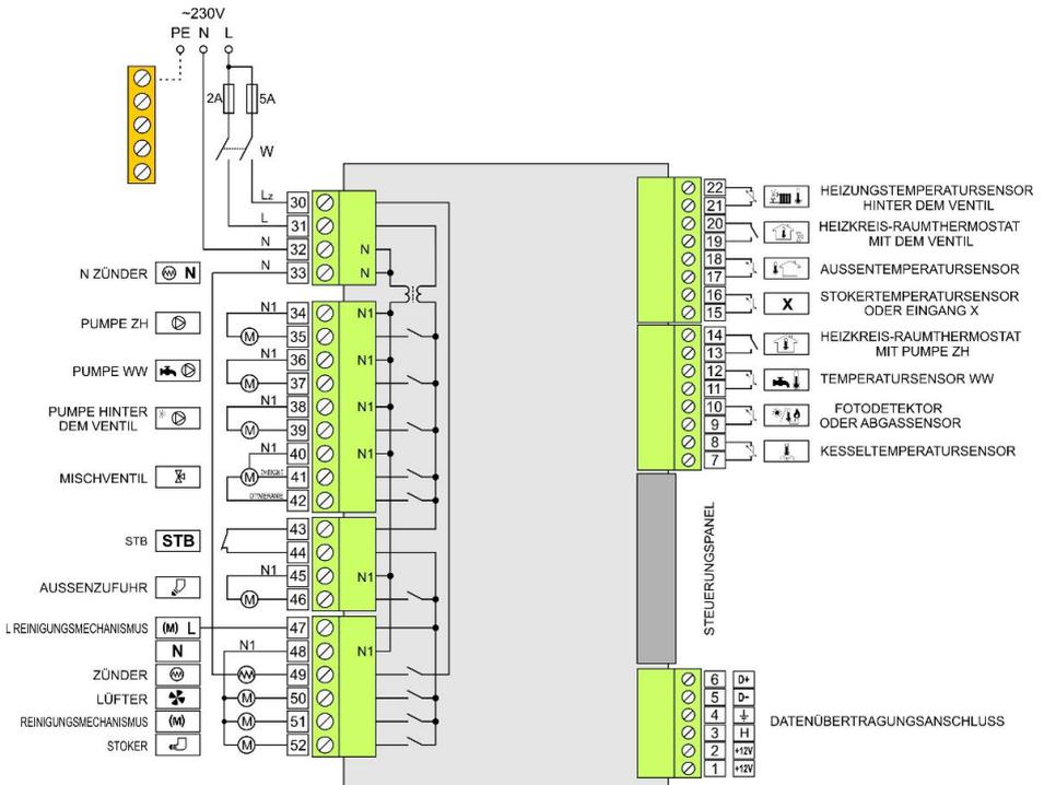
Anschlusschaltplan des Reglers RK-2006SPGM mit Netzgerät MZK, MZM2 Version V.05.2018
