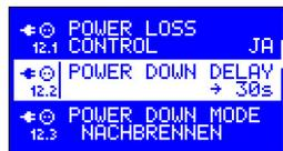
**12.1 Überwachung des Stromausfalls** – der Regler verfügt über eine Funktion der Überwachung des Stromausfalls, damit er ununterbrochen betrieben werden kann. Falls die Speiseschaltung mit einer unterbrechungsfreien Stromversorgung und einem Stromausfalldetektor ausgestattet ist, schaltet sich der Regler im Falle eines Stromausfalls auf Notstromversorgung um.
