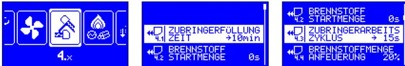
**4.1 Zeit der Füllung des Zubringers** – der Parameter bestimmt, wie lange der Zubringer in Betrieb sein sollte, damit der Hauptzubringer mit dem Brennstoff nachgefüllt wird.
