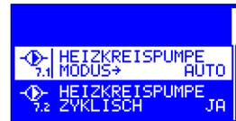
**7.1 Einschaltungsmodus der Heizungspumpe** – der Parameter bestimmt die Weise, auf die die Heizungspumpe eingeschaltet wird. Die Einstellung des Werts TERM bedeutet, dass die Heizungspumpe nur bei geschlossenen Kontakten des Raumthermostats und in Notfällen (z.B. Kesselüberhitzung) eingeschaltet wird. Das Vor-
