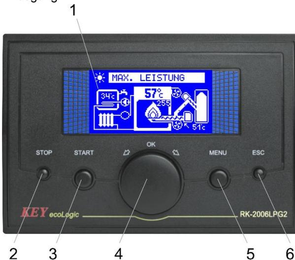
Die grundlegende Bedienung besteht in einer Einstellung der Kesselsolltemperatur. Zu diesem Zweck, sollte ein gewünschter Wert durch Drehen des Drehknopfes (4) gewählt und mit der Taste OK (Drücken des Drehknopfes) bestätigt werden.
