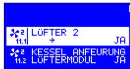
**11.1 Gebläse 2** – das Einstellen des Parameters auf Wer VORHANDEN bedeutet, dass ein zusätzliches Gebläse verwendet werden kann..
