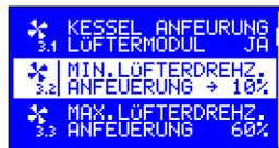
**3.1 Modulation der Gebläseleistung während der Anzündung** – wenn dieser Parameter auf Wert JA eingestellt wird, wird dann die Modulation der Gebläseleistung während der Brennstoffanzündung eingeschaltet.
