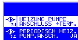
**7.1 – Einschaltmodus der Pumpe ZH** – dieser Parameter bestimmt, wie die Pumpe ZH aktiviert wird. Ist der Wert auf „THERMOSTAT“ gesetzt, bedeutet dass, die Pumpe ZH nur bei kurzgeschlossenen Kontakten der Raumthermostaten und Notfällen (z.B. Überhitzung des Kessels). Ist der Wert auf „AUTO“ gesetzt, bedeutet dass, die Pumpe ZH unabhängig von der Raumthermostat arbeitet.
