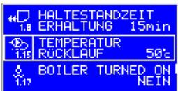
**1.17 – Kessel eingeschaltet** – dieser Parameter informiert, ob der Kessel eingeschaltet ist und ermöglicht den Kessel ein- oder auszuschalten.
