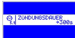
**5.1 – Dauerzeit der Brennstoffzündung** – der Parameter bestimmt, wie viel Zeit es nach dem Anschluss der Glühkerze (des Zünder) nötig ist, um den Brennstoff anzuzünden.
